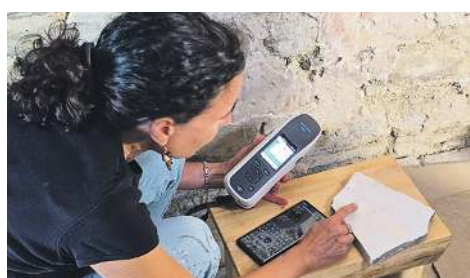
Kolorimetrija – usporedba boje izvornog arriccia i boja zamiješanih za reintegraciju oštećenja (na slici: dr. sc. Katja Kavkler)
