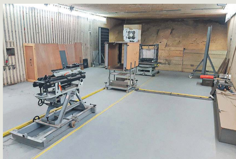
Ispitivanje novorazvijenih ploča prema EN 1522 u akreditiranom laboratoriju u Češkoj
