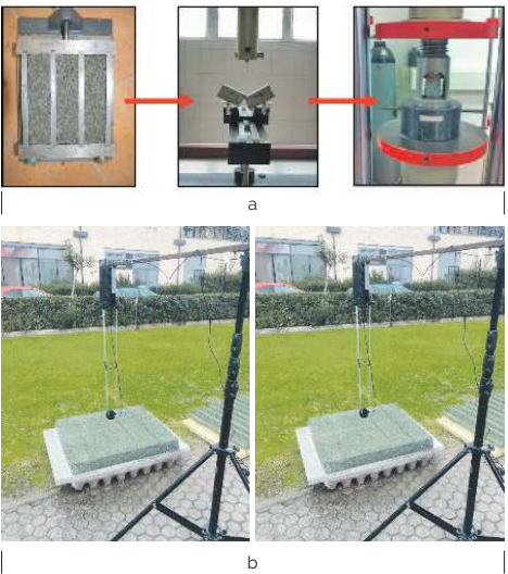
Ispitivanje mehaničkih (a) i akustičkih (b) svojstva RUCONBAR barijere s povećanim udjelom granula gume
