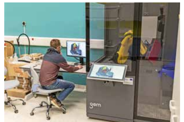
Docent Tin Brlić radi na 3D optičkom stereofotogrametrijskom mjernom sustavu
