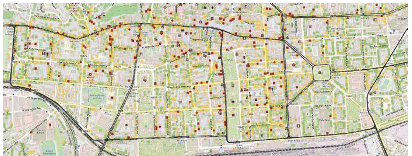
SLIKA 2: Prikaz zagrebačke tramvajske mreže u užem centru grada s prikazom zgrada nakon inicijalnog pregleda; označene kao uporabljive (zeleno), privremene uporabljive (žuto) i neuporabljive (crveno)
